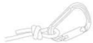
Рисунок. 6. Баррел (применяется только для крепления к карабину самостраховки)
