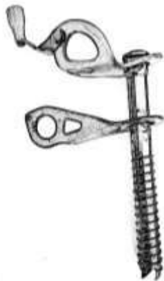
Рисунок 20. Использование ледобура с дополнительной проушиной для карабина
